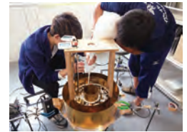
大気循環を再現する回転水槽実験の準備
