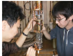
希釈冷凍機を使った実験の準備
