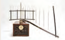
八木秀次・宇田新太郎が発明 八木・宇田アンテナ (電気通信研究所)
