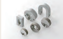
本多光太郎が発明 KS鋼・新KS鋼 (金属材料研究所)
