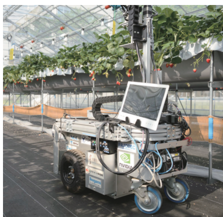
工農連携 イノベーションファーム内のイチゴ収穫ロボット
